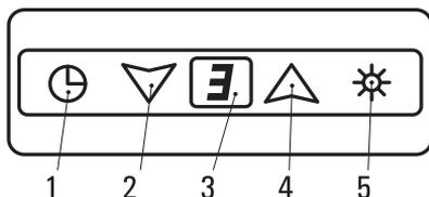
Ваша вытяжка имеет 4 скорости вентиляции. В зависимости от того, насколько велики испарения при готовке и жарке, Вы можете выбрать низкий, средний или высокий уровень вентиляции или режим «турбо» (4-я скорость вентиляции).
